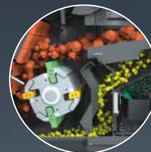
Flux de matériau optimisé du convoyeur vibrant à la bande de sortie principale
