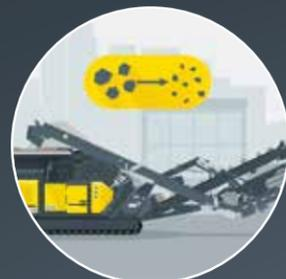
Circuito chiuso del materiale - vaglio a rete con nastro di ricircolo integrato e classificatore ad aria opzionale. Grano finale vagliato in un solo passaggio.
