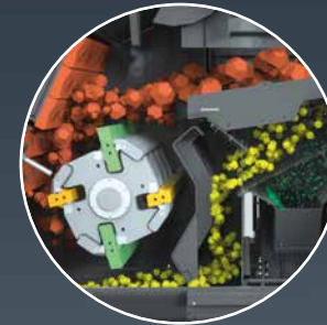
Optimierter Materialfluss von der Vibratorrinne bis zum Hauptaustrageband
