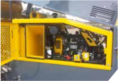
Grandes portes d'accès au compartiment moteur
