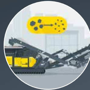
Circuit du matériau fermé : crible à maille avec convoyeur de retour intégré et aéroséparateur en option pour un grain final criblé en une seule étape
