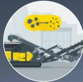
Geschlossener Materialkreislauf – Maschendecksieb mit integriertem Rückführband und optionalem Windsichter. Abgesiebtes Endkorn in nur einem Arbeitsgang
