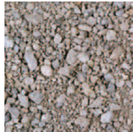
再生混凝土图骨料
