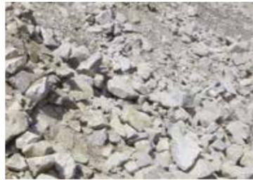
Materiale da processare: granito mass 200 mm
