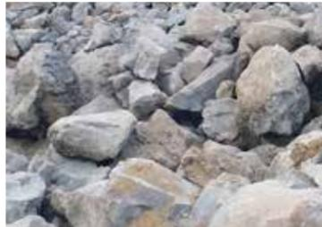
Materiale da processare: basalto 70 - 200 mm
