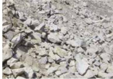
Material de alimentación: granito hasta 200 mm
