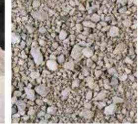
Granulats de béton recyclés
