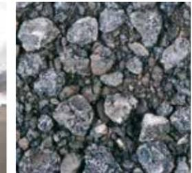
Granulats d'asphalte recyclés
