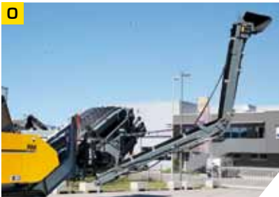
Nastro di ritorno abbassabile • si crea un circuito chiuso che riporta il fuori misura al frantumatore oppure se disposto in obliquo, permette di deporre il materiale lateralmente
