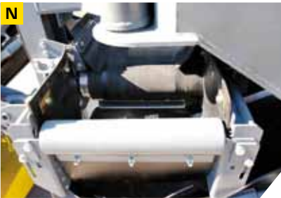
Crivello • separa efficacemente le parti leggere dal granulato • regolabile facilmente per soddisfare diverse richieste
