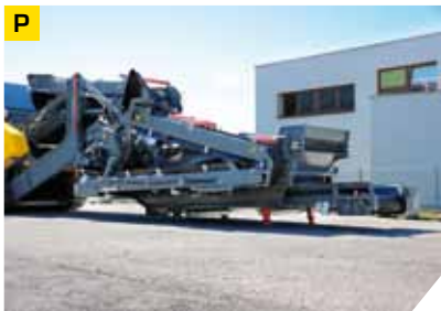
Vaglio MS abbassabile • aumenta l'accessibilità al fondo del vaglio • cicli di manutenzione più semplici • semplice smontaggio dalla macchina
