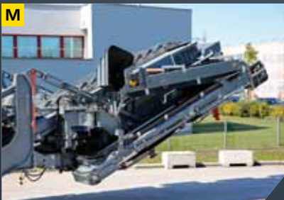
Trasporto • possibilità di trasportare il vaglio MS sulla macchina o separatamente
