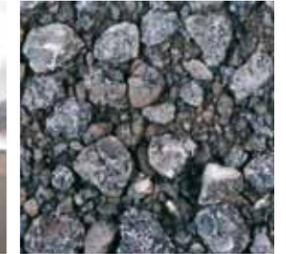
Granulado de asfalto reciclado
