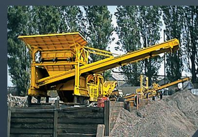
Hauts cônes de déversement avec les 2 skids additionnels et la bande latérale optionnelle de 8m de long.
