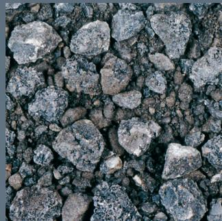
Granulats d'asphalte recyclés
