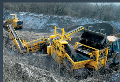
Efficacité maximale – en crible autonome ou combiné avec un concasseur RM pour former un centre complet de recyclage sur site.
