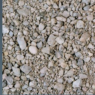
Granulats de béton recyclés
