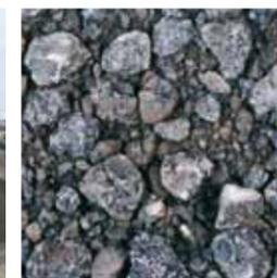
Granulado de asfalto reciclado
