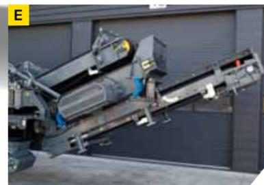
**Criba de cubierta de malla RM MS95GO! con cinta de retorno giratoria**
