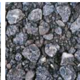
Granulado de asfalto reciclado
