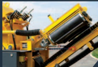
Indispensable: le Release System pour l'élimination des blocages et le séparateur magnétique éprouvé.
