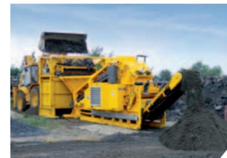
Usure réduite grâce au précriblage: le robuste VS60 - avec bande latérale au choix - sépare les fines du matériau à concasser.
