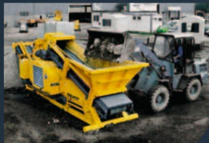
Manipulation simple: alimenté par de petits engins (hauteur de chargement 1930 mm), radiocommande en option.
