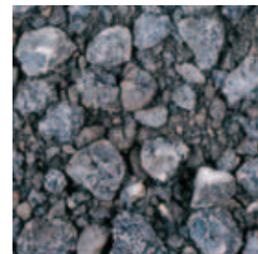
Granulado de asfalto reciclado
