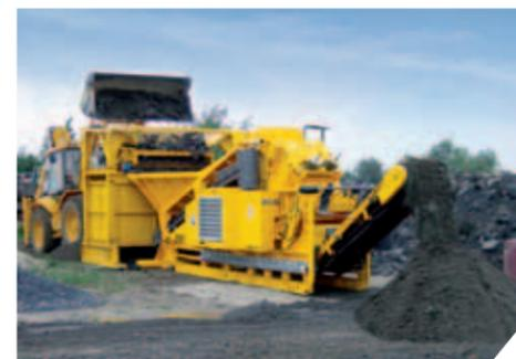
Menos desgaste gracias al pre-cribado: la robusta criba RM VS60 (opcionalmente con cinta de descarga lateral) separa los finos del material de alimentación.
