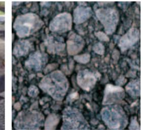
Granulats d'asphalte recyclés
