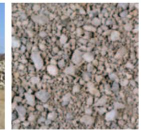
Granulats de béton recyclés
