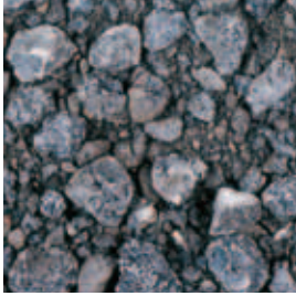
Granulado de asfalto reciclado
