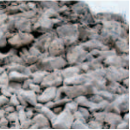
Restos de hormigón
