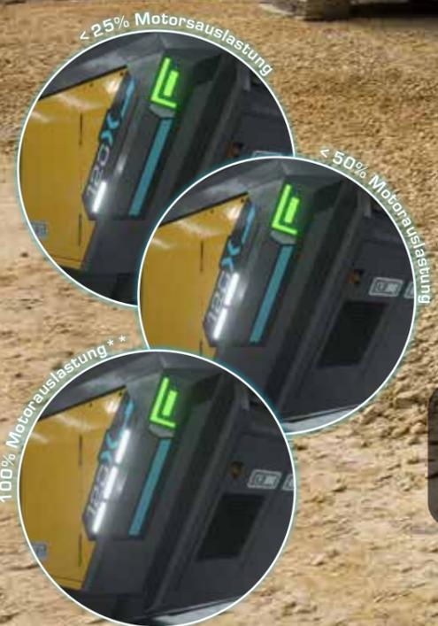
Die Leistungsanzeige hilft Ihnen, die perfekte Aufgabegeschwindigkeit zu finden, um so die Durchsatzleistung intuitiv zu erhöhen.
