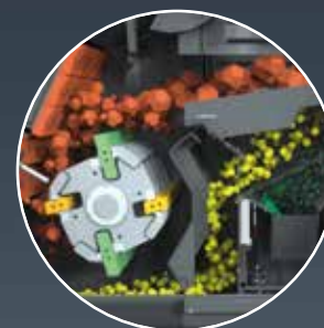
Óptimo flujo de material desde el canal vibrador hasta la Cinta principal de descarga
