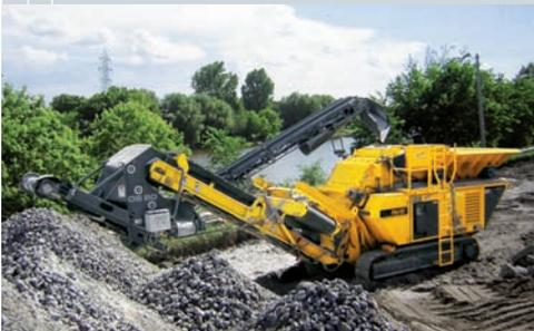
Definiertes Endkorn in einem Arbeitsgang mit nur einem Betreiber im geschlossenen Kreislauf
