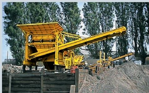
Hohe Schüttkegel durch 2 Zusatzkufen und optionales Seitenförderband mit 8 m Länge
