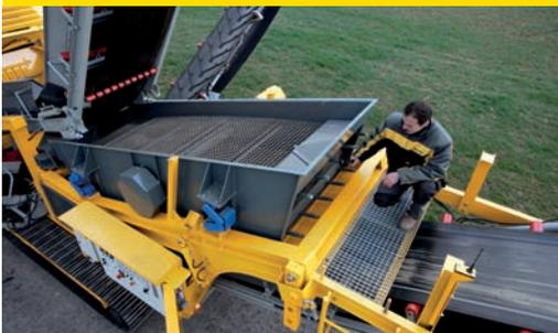
Ertrag durch Effizienz: großflächige Siebbox, Beläge für jedes Material, kurze Rüstzeiten, Service vom Boden aus
