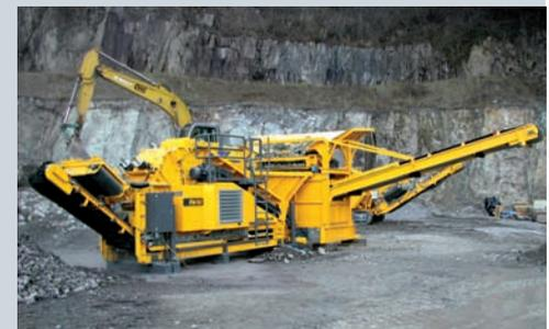
Größtmöglicher Durchsatz im Brecher bei geringem Verschleiß – dank Vorabsiebung der Feinteile
