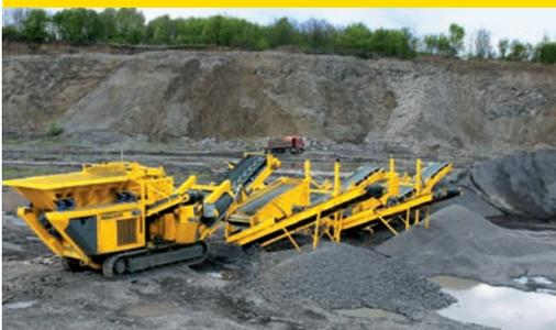
Modulares System für mobile Baustoffproduktion: dank Stromversorgung vom Brecher auch auf abgelegenen Baustellen autark
