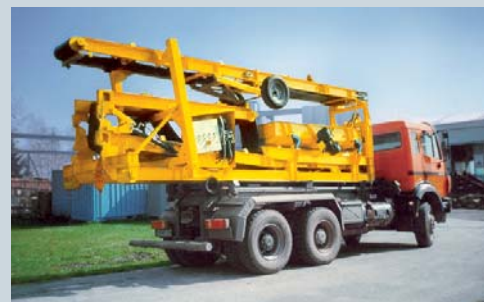
Compact, léger et mobile : le CS2500 transporté par système ampli-roll est rapidement sur le chantier
