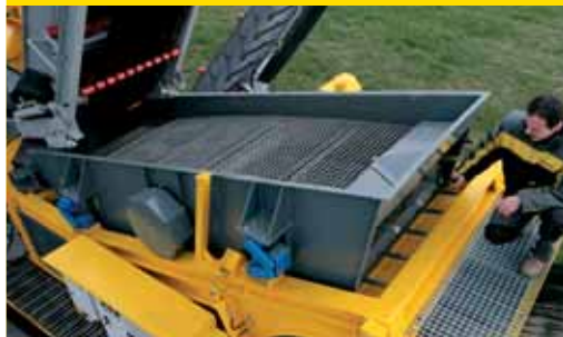
Crible de grande surface avec 2 ponts de tailles identiques pour un maximum d'efficacité et une réduction de la durée de mise en marche.
