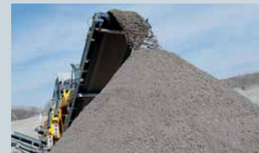
Bandes de rejet repliables extra longue hydrauliquement, réglables en continu jusqu'à une hauteur de déversement de 4 mètres.
