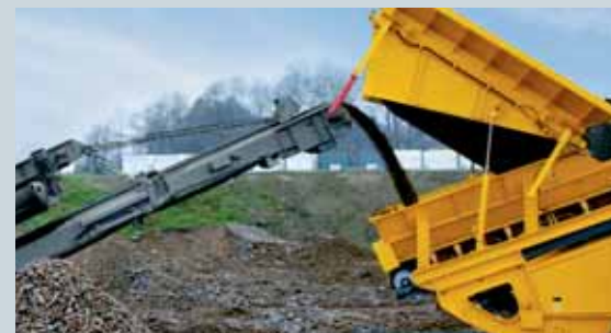
Possibilité d'alimenter directement le TS3600 par le biais d'un concasseur RUBBLE MASTER.
