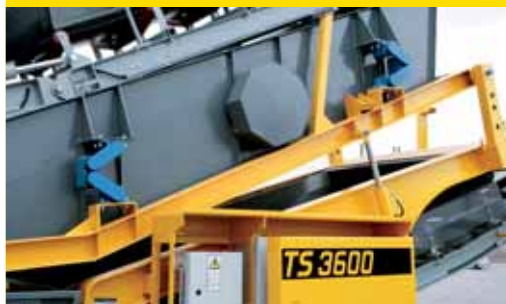
Angle d'inclinaison réglable hydrauliquement jusqu'à 25° pour les matériaux fins et difficiles à cribler.
