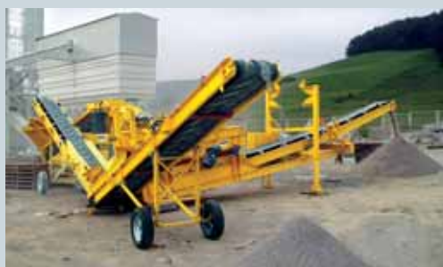
Créneaux rentables : les déchets de production sont classés par le CS2500 mobile de type conteneur et transformés en produits finis à haute valeur marchande
