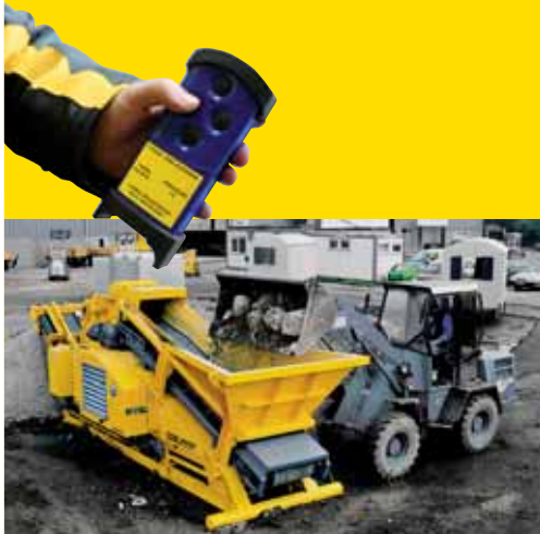
Manipulation simple : chargé par de petits engins (hauteur de chargement 190 cm), radiocommande en option
