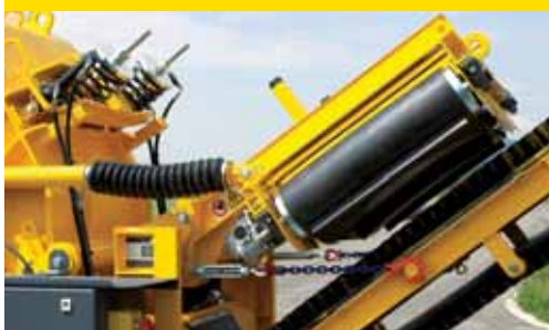
Indispensable : Release-System pour la suppression des blocages et séparateur magnétique fiable
