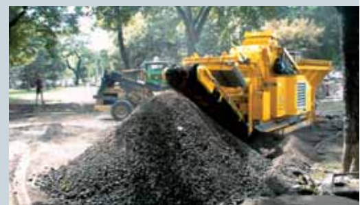
Réussite basée sur la qualité : jusqu'à 80 t/h de granulats cubiques de qualité à partir de gravats, d'asphalte, de béton, de briques et autres matériaux
