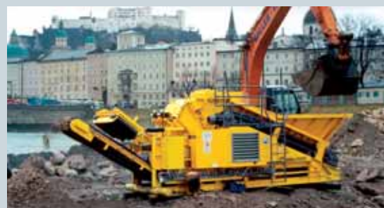
Apprécie par les riverains : système de dépoussiérage et capotage insonorisant de série
