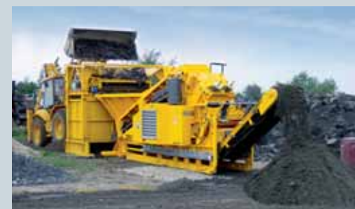
Usure réduite grâce au précriblage : le VS60 robuste – avec bande latérale au choix – sépare les fines du matériau à concasser
