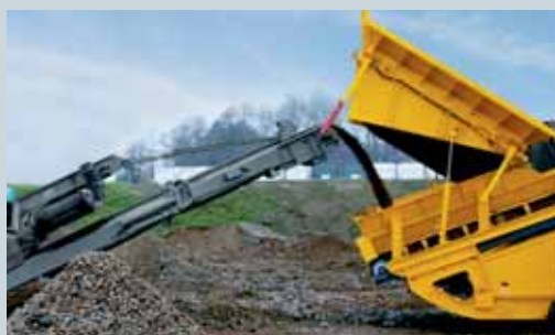
Valeur ajoutée grâce à des granulométries classées: le TS3600 parfaitement adapté au RM100 peut être directement alimenté par le concasseur.
