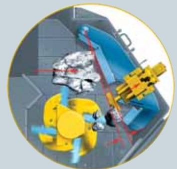
Suppression des blocages par radiocommande: le Release System laisse passer les blocs trop volumineux sur simple pression d'un bouton.
