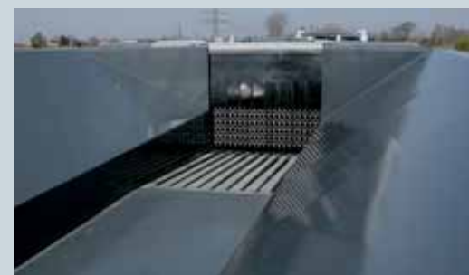
Capacité de transport maxi: la goulotte vibratoire de conception spéciale assure un excellent comportement à l'alimentation.
