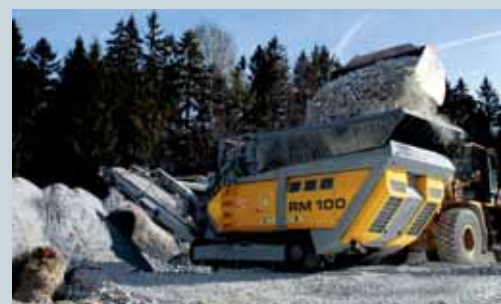
250 t/h de granulats réguliers 0/70 mm: le RM100 prouve sa force en tant que concasseur primaire dans les gravières.
